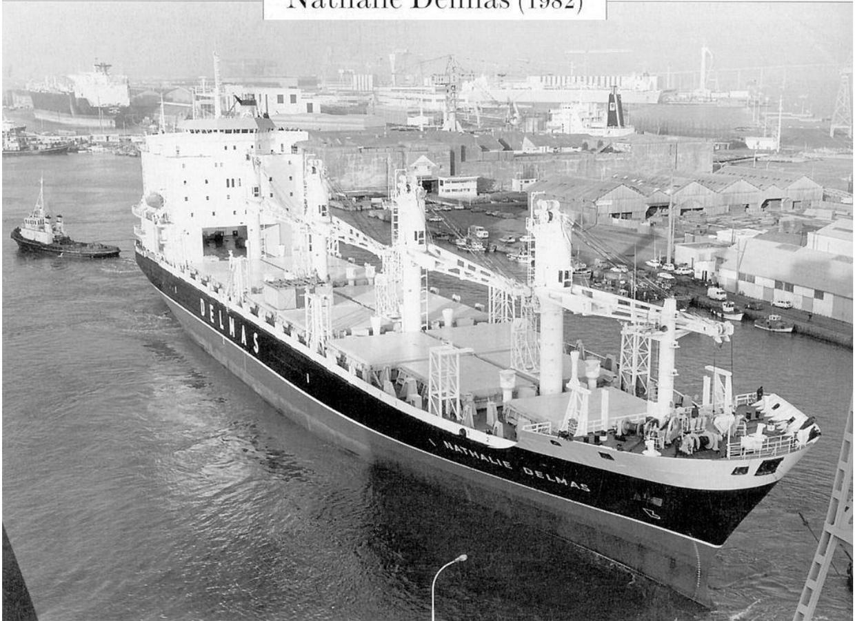
Porte-conteneurs double coque à un pont continu de type ouvert. Château arrière, bulbe d'étrave et arrière à tableau.
